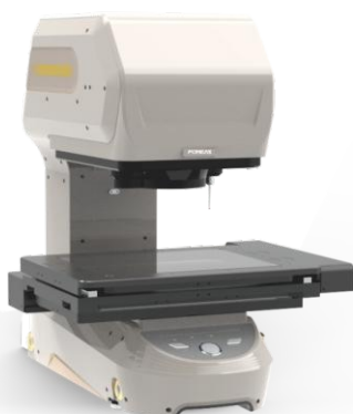
IMAGE 3 MAX2 廣視野測量範圍225*125*75mm 搭載普密斯8055光譜探頭
